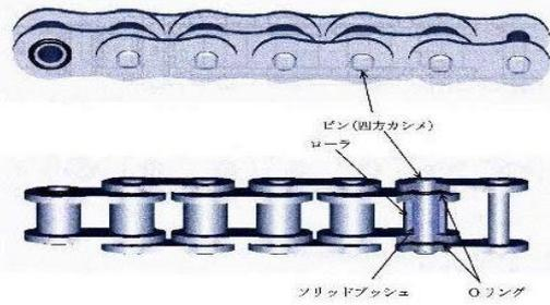
PULTONリーフチェーンは、チェーンの外プレートと内プレートの上にOリングを入れる事により、当社標準チェーンに比べて摩耗伸び寿命が長く、騒音を低減する事ができます。
